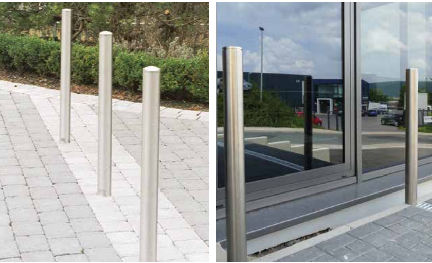
Edelstahlpfosten Ø 76 mm, geschliffen, gewölbte Kopfform, Überflur ca. 900 mm
