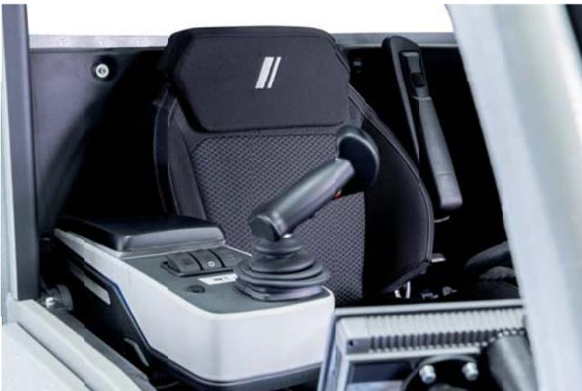
Joystick mit ergonomisch angeordneten Bedienelementen
