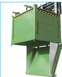
Behälter mit Bodenklappen bieten bei der kompakten Bauform ein optimales Füllvolumen, und durch den günstigen Lastschwerpunkt ist eine volle Ausnutzung der Staplertragfähigkeit möglich. Der große Öffnungsbereich der einteiligen Bodenklappe bietet dabei eine vollständige Entleerung auch bei sperrigem Material mittels Zugseilentriegelung.
