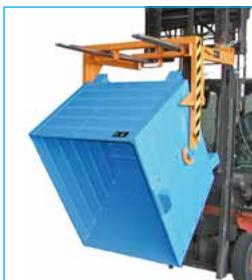
Diese Behälter haben keinen integrierten Kippmechanismus und sind somit eine preiswerte Alternative. Unabhängig von der eingesetzten Behälterstückzahl ist bei identischer Breite der Behälter nur eine Entleertraverse für den Kippvorgang erforderlich. Für die Behälter ohne Aufnahmezapfen wird ein vorhandenes Drehgerät am Gabelstapler sowie durchgehende Einfahrtaschen am Behälter zur Entleerung vorausgesetzt.
