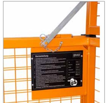
Sicherung der abklappbaren Schutzgitter Kurzanleitung
