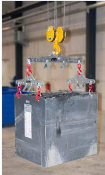
Kombination aus mehreren Traversen zur H-Traverse
