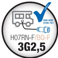
Zu beachten sind allgemeingültige Richtlinien zur Stromversorgung auf Campingplätzen und im Reisemobil. Laut DIN Norm VDE 0100-721 sind sogenannte schwere Gummischlauchleitungen mit der **Leistungsbezeichnung H07RN-F** oder höherwertige mit einem **Kabelquerschnitt von 2,5 mm<sup>2</sup>** (3G2,5) gefordert. Zudem darf die **Maximallänge von 25 m** Leitung **plus** ggf. **1,5 m Adapterleitung** nicht überschritten werden.
