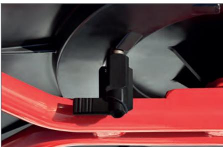
Fahrgestell mit massiver Bremse
