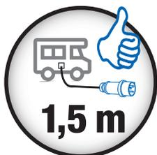
Betrachtet man die **Sicherheit** in Bezug auf den Umgang mit Strom ist zudem der Einsatz elektrischer Produkte mit einer **Kabellänge nicht unter 1,5 m** ratsam. Diese Kabellänge ermöglicht es z. B. Verlängerungsleitungen an einer höhergelegenen Wandsteckdose oder Einspeisungsdose anzuschließen und die **Leitung mit samt der Kupplung auf dem Boden, z.B. unter dem Fahrzeug, abzulegen**.
